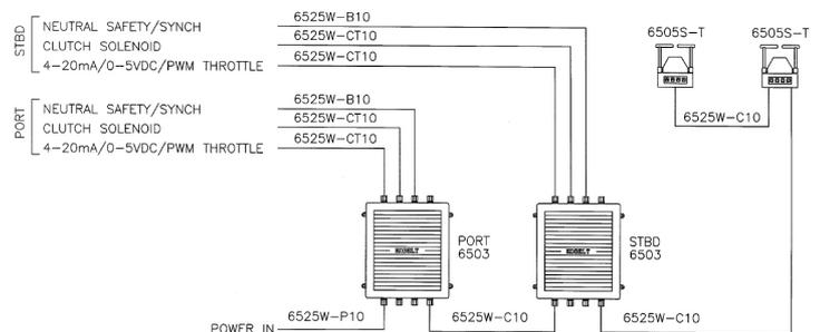
Die Reihenfolge, in der die Einheiten angeschlossen werden, spielt keine Rolle. Man kann sie also in der baulich optimalen Reihenfolge verdrahten. An jedem der Fahrstände haben Sie die vollkommene Kontrolle über das System, seinen Status, eventuelle Alarmer oder sonstige Funktionen.
