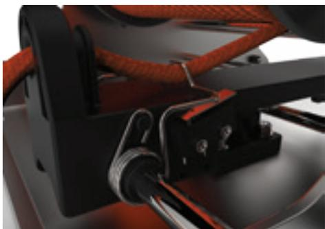
Der Komposite Ankerleinen Führungsarm besitzt eine Nutzmasse Erkennungs Einrichtung.
