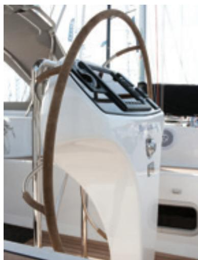
Speziell von Lewmar entwickelter Gunfleet Flightdeck- Steuerstand, mit von hinten montiertem Steuerrad und großer Bildschirmanzeige.
