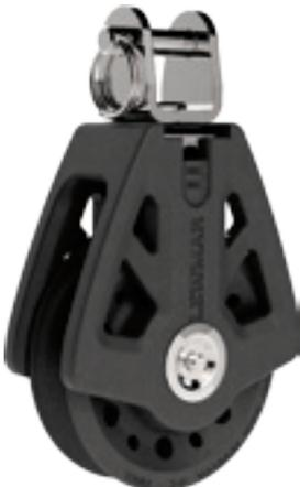
Der Gabelkopf der Fallenblöcke wurde so konzipiert, dass er zu den meisten Stehbolzen an Mastspuren passt – vergleichen Sie den Kopfdurchmesser mit der Gabelweite (A) und dem Bolzendurchmesser (B)
