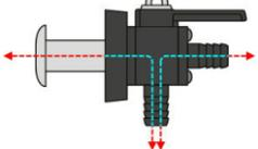
**Y-SEEVENTIL MIT GERADER UND 90 GRAD SCHLAUCHTÜLE UND BORDDURCHLASS (VERSENKT ODER PILZKOPF)**
