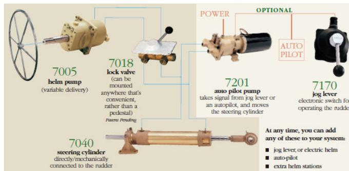
Optimal sollte noch ein 7020 Sicherheitsventil vor den Zylinder geschaltet werden.
