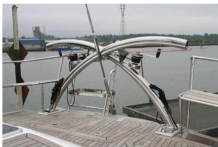
Diese innovativen Davits sind eine neue stylische Ergänzung zu den bisherigen Simpson Davit Modellen. Dieses System hebt den Tender mittels einer Talje (manuelle Bedienung über eine horizontal montierte Seilwinde) in ausreichendem Abstand zur Badeplattform. Sobald der Tender oben ist, wird er eingeklappt und sicher unter den Davits geborgen.
