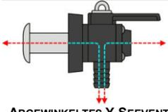
**ABGEWINKELTES Y-SEEVENTIL MIT SCHLAUCHTÜLE UND AUFNAHME FÜR EINE WEITERE SCHLAUCHTÜLE BORDDURCHLASS (VERSENKT ODER PILZKOPF)**
