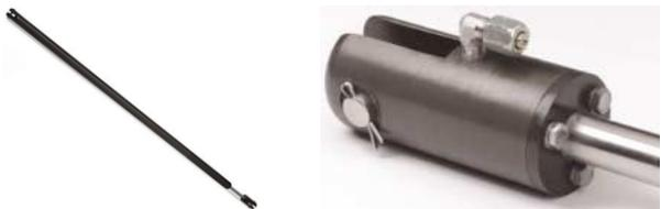
Die Baumniederholerzylinder bieten neben der hydraulischen Niederholerfunktion ein internes Stickstoff Gasdruckpolster, mit dem der Baum kräftig angehoben wird. Im Normalfall werden so Baum und Segel bei Nicht Einsatz (im Hafen) vom Baumniederholer getragen. Das erspart Ihnen im Normalfall die Dirk.
