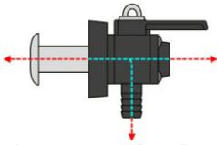
**ABGEWINKELTES DUAL DRAIN SEEVENTIL MIT SCHLAUCHTÜLE, AUFNAHME FÜR EINE WEITERE SCHLAUCHTÜLE UND BORDDURCHLASS (VERSENKT ODER PILZKOPF)**
