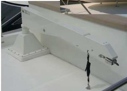
Bilder: Whisper David WD800, eingefahren. Links mit Aluminium-Pyramiden-Decksfuß, oben und unten die Standrohr Version.
