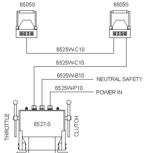
Der Mighty Mariner kann eine oder zwei Maschinen an ein bis vier Fahrständen verwalten. Die Einheiten werden miteinander durch einen CAN Datenbus über ein einzelnes Kommunikationskabel verbunden. Maximale Kabellänge ist 40m.
