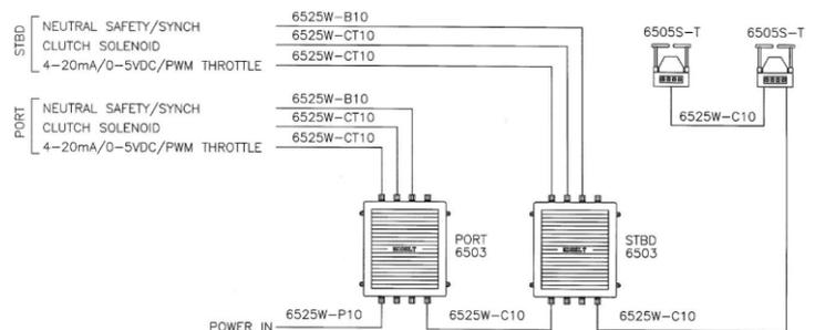
Die Reihenfolge, in der die Einheiten angeschlossen werden, spielt keine Rolle. Man kann sie also in der baulich optimalen Reihenfolge verdrahten. An jedem der Fahrstände haben Sie die vollkommene Kontrolle über das System, seinen Status, eventuelle Alarime oder sonstige Funktionen.
