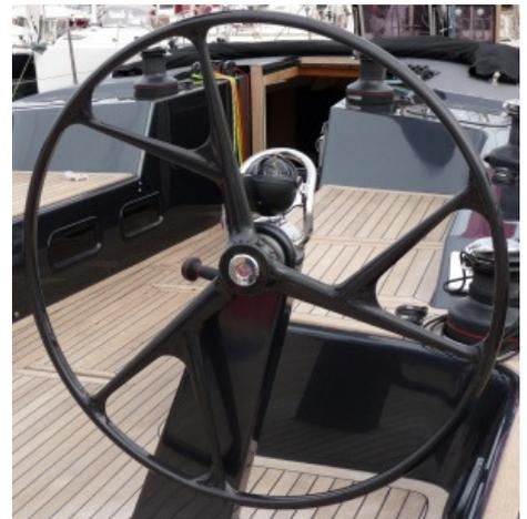
Die Solimar Steuerradnabe ist zylindrisch 25 x 60mm, mit einer 6mm Passfedernut. Solimar Steuerräder können aber auch mit Naben-Maßen für andere Steuersäulenfabrikate als hergestellt werden (z.B. für 25mm konische Welle).
