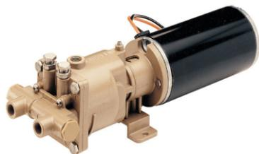
Elektrische Hydraulikpumpe für unterbrochenen Einsatz. Optimal als Autopilotantrieb für Yachten von ca. 35 - 45 Fuß Länge. Mit Sicherheitsventil rechts und links. Wir liefern diese Pumpe nur ohne integrierte Relais. Einstellbare Fördermenge. Maximalleistung ca. 4 Liter./min bei 150 PSI, etwa 10 Bar, oder 0.7 Liter/min bei 1000 PSI, etwa 70 Bar. Achtung, diese Pumpe ist nicht als Heavy Duty Dauerläufer konzipiert. Das Aggregat hat keinen integrierten Öltank.
