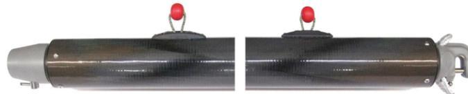
Beschreibung des UTR siehe voriger Abschnitt. Der UTS Endbeschlag ist der Mastbeschlag für größere Offshore Spinnakerbäume, mit Schnellöffner. Mastzapfen und Toggle sind entweder mit Forespar Mastrutscher lieferbar, oder ohne Mastrutscher, dann passend für Harken und andere Rutscherfabrikate.
