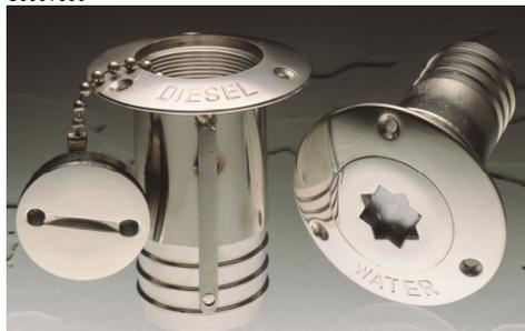
Tankfüllstutzen aus mechanisch verarbeitetem Edelstahl (also kein Guss!), hochglanzpoliert, in verschiedenen Ausführungen.
