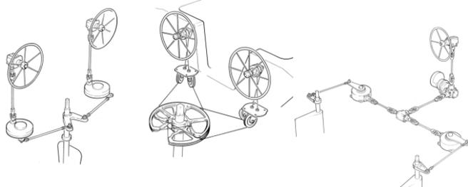
Beispielhafte Variationsmöglichkeiten für zwei Ruder und / oder zwei Steuerstände
