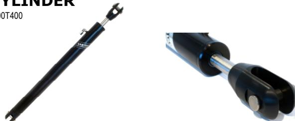
Sailtec Zylinder sind standardmäßig aus Aluminium hergestellt, poliert und hart eloxiert. Sie sind reine Zug-Zylinder (nur ein Schlauch am Zylinder). Optional sind Edelstahlzylinder und Zylinder mit besonderem Hub bis 2500mm verfügbar - sowie Zug- Druck-Zylinder. Die obere Gabel ist aus Aluminium gefertigt und mit Loctite aufgesetzt. Auf Wunsch liefern wir Zylinder mit offenem Gewinde auf dem Kolben, zur Aufnahme eines Wartenspannergehäuses oder anderer Spezialfitting.
