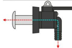
**EINFACH-SEEVENTIL MIT 90 GRAD SCHLAUCHTÜLLE UND BORDDURCHLASS (VERSENKT ODER PILZKOPF)**
