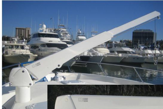
Bild links: ES1000 in Einsatzposition. In der Ausführung mit Standrohr Fuß.
