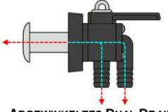
**ABGEWINKELTES DUAL DRAIN SEEVENTIL MIT ZWEI SCHLAUCHTÜLEN UND BORDDURCHLASS (VERSENKT ODER PILZKOPF)**
