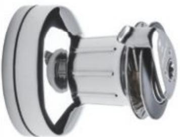
Das modulare Powersystem von Andersen erlaubt es die Winschen 28 ST bis 72 ST nachträglich mit einem elektrischen oder hydraulischen Antrieb auszurüsten.
