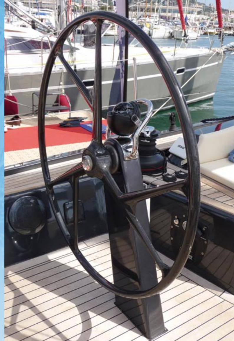
Cette colonne a une conception semblable à celui de la colonne 609B, elle nous ramène aux mêmes paramètres de projet, mais elle est moins profonde. Cette différence la rend plus adaptée aux petits bateaux. La 609I doit être laminée au pont pendant la construction et devenir un corps seul avec le bateau. Elle est disponible aussi en version 609G avec une base pour faciliter l'installation.
