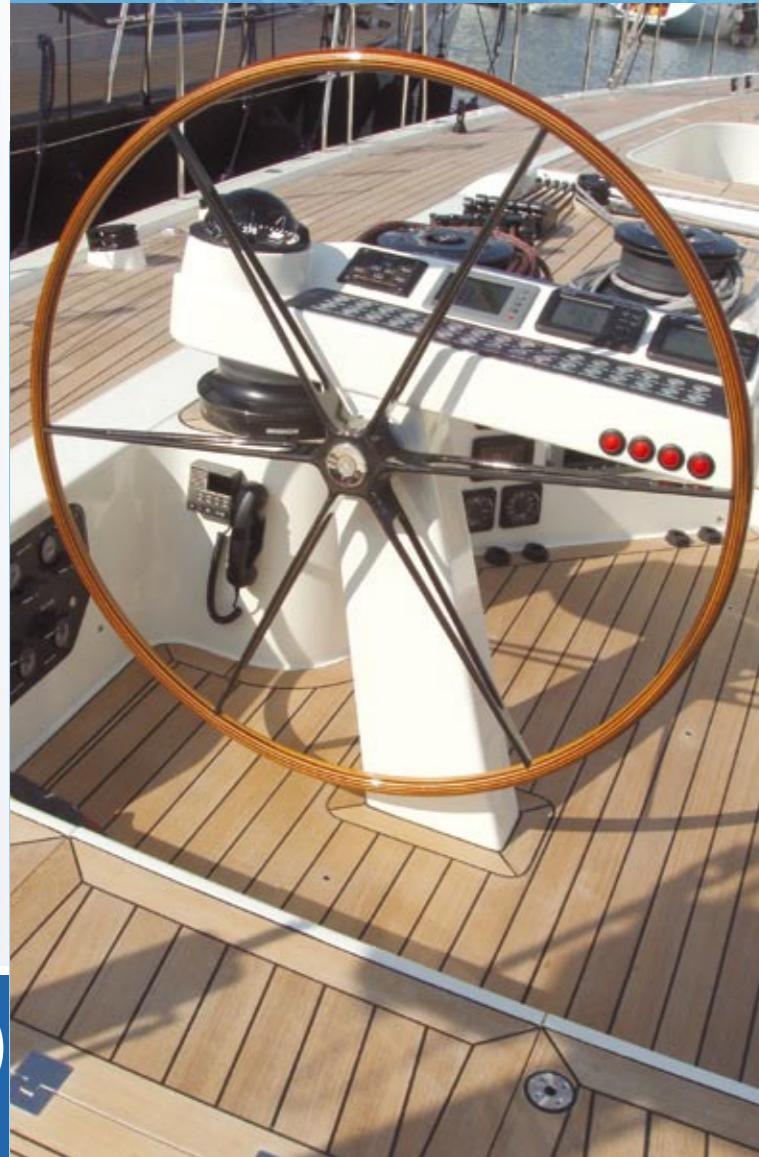
Colonna di design molto classico, si adatta ad essere installata con qualsiasi angolazione. La conformazione della parte superiore è esplicitamente progettata per essere completata con una console anche di dimensioni generose. La 609F deve essere laminata alla coperta in fase di costruzione per diventare così corpo unico con il resto dell'imbarcazione.
